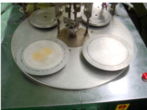
洋菓子成型の工程では、連続して自動的に成型機によってトルテ型（三角形）にされますが、成型不具合が発生すると形状の大小が発生し多量の廃棄物となります。
