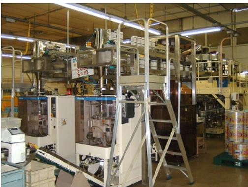
菓子包装の工程では、連続して自動的に包装機によって密封されますが、包装不良（充填不具合）が発生すると多量の包装フィルムが廃棄物となります。
